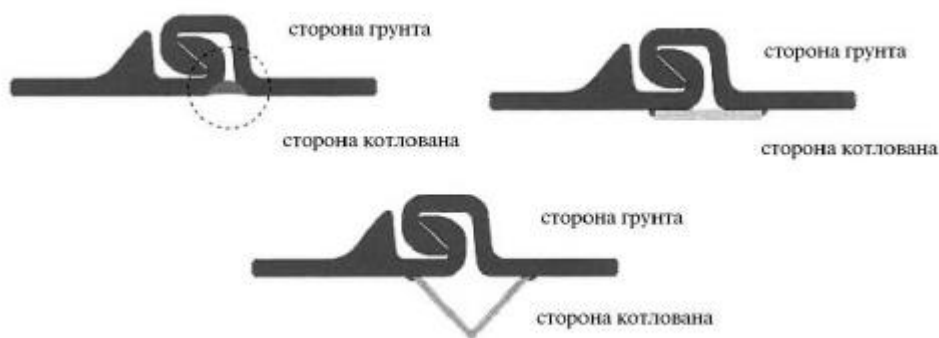
Рис. 7 Варианты сварки замковых соединений стальных шпунтовых свай, обеспечивающее водонепроницаемость подпорной стены.
