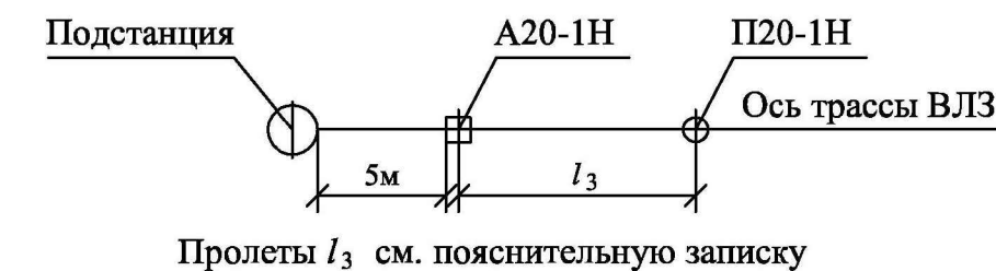
Схема 2 установки на ВЛЗ А20-1Н в качестве концевой опоры
