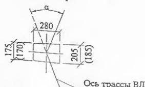
Схема установки стойки опоры
